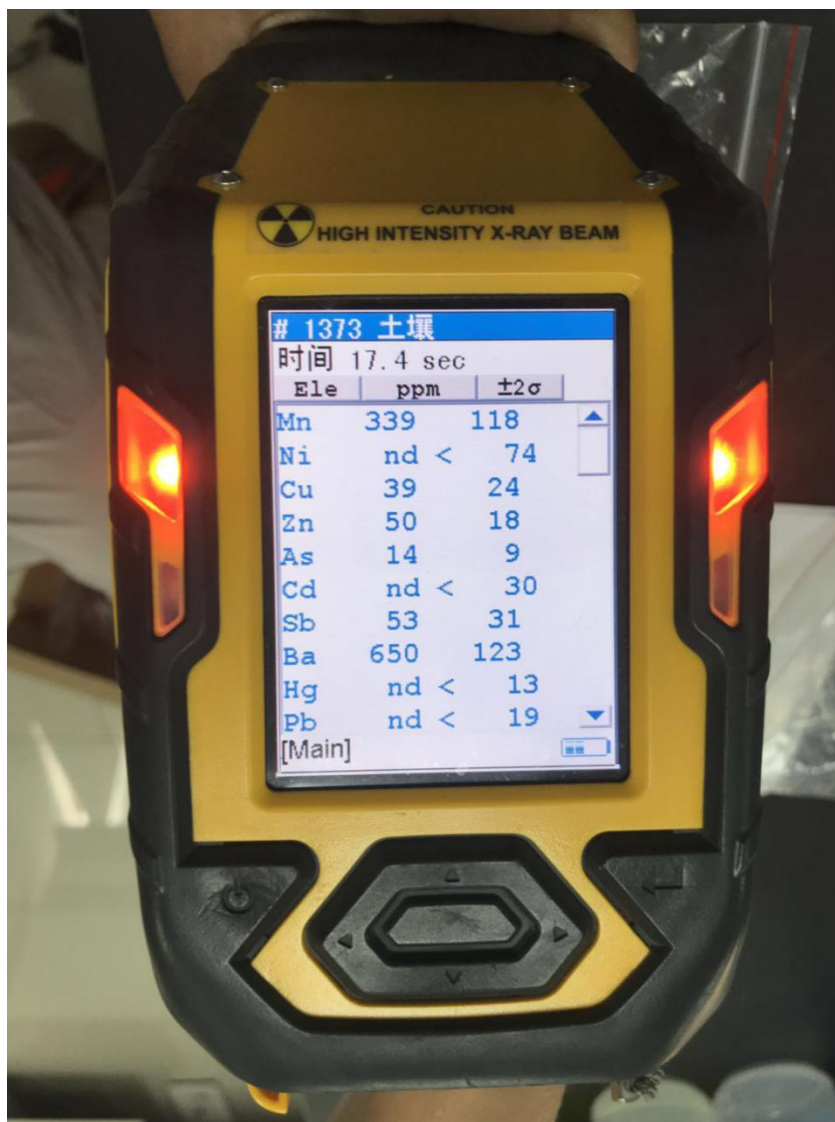
图 9.4.2-3 XRF 快速检测设备
