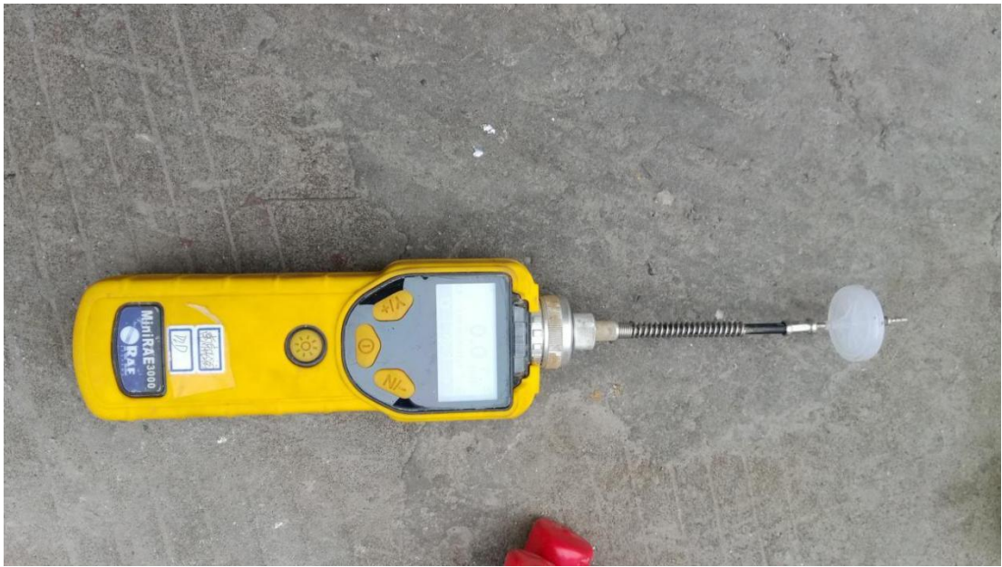
图 9.4.2-2 PID 快速检测设备
