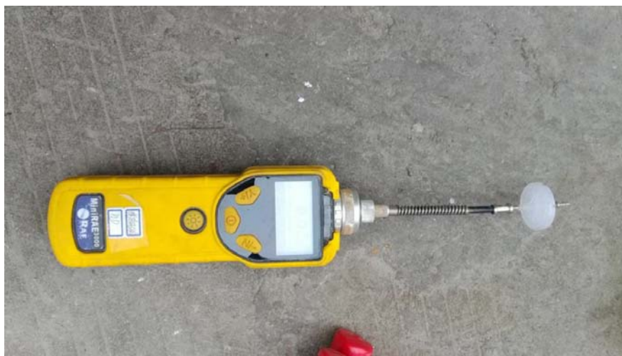
图 9.4.2-2 PID 快速检测设备
